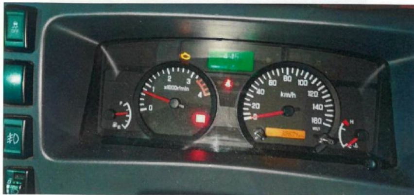
Detalle del cuadro con fallo de motor
