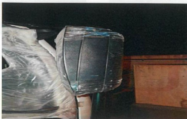
Retrovisor derecho carcasa envuelta con cinta adhesiva
